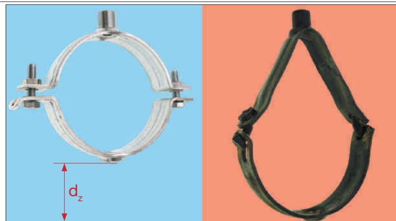
Slika 6.3: Obujmica cijevi Stabil D-3G prije i nakon požarnog pokusa / Sikla
